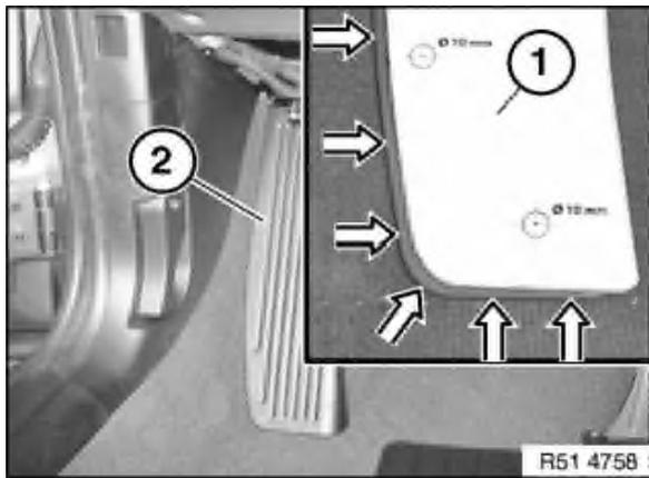
Наложить кондуктор для сверления (1) на подставку для ноги (2) и выровнять по наружному краю подставки (2). (см. стрелки)
